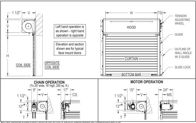
\*"AUTO-RESET" INCREASES HEIGHT OF CHAIN & CRANK OPERATORS BY APPROXIMATELY 3"
