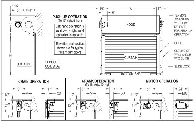
\*"AUTO-RESET" INCREASES HEIGHT OF CHAIN & CRANK OPERATORS BY APPROXIMATELY 3"
